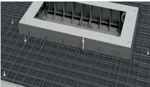
4. „Schöck Isolink®“ tipo C-SH montavimas į pragręžtą termoizoliacinį sluoksnį
